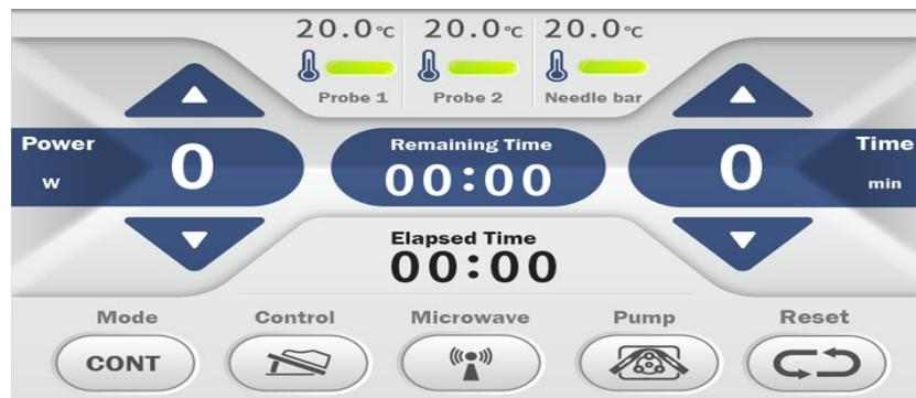
En la interfaz de trabajo de la Figura, se distribuyen el control de cada unidad del sistema, la configuración de los parámetros de trabajo y la visualización de los parámetros del proceso de operación del host. Al tocar o hacer clic en el área de visualización de temperatura de la interfaz de trabajo de la Figura anterior, se accederá a la interfaz de visualización y configuración de "Sobretemperatura" y "Control de temperatura", como se muestra en la siguiente figura.
